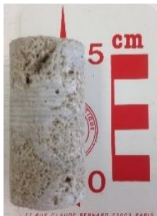
Figure 3 : Exemple de petite carotte échantillonnée sur le puits CAY-1ST. Il apparaît visuellement la porosité du réservoir.
